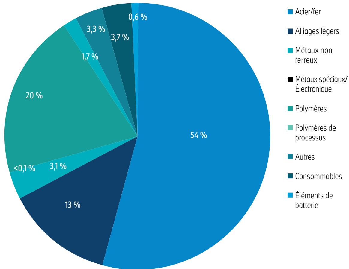
Fig. 2 : Composition des matériaux de la BMW X2 sDrive20i au lancement de la production. Les valeurs indiquées peuvent diverger une fois arrondies.
