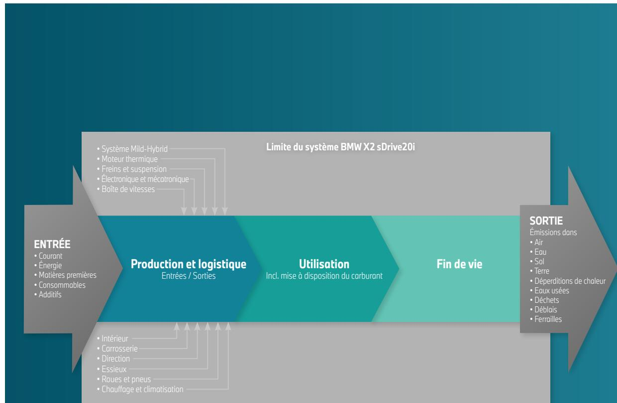
Fig. 1 : limites du système pour l'écobilan de la BMW X2 sDrive20i
